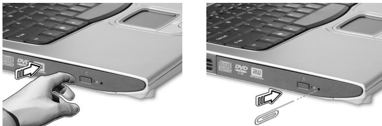
Quando è spento, è possibile espellere il vassoio del drive utilizzando il foro di apertura di emergenza.
