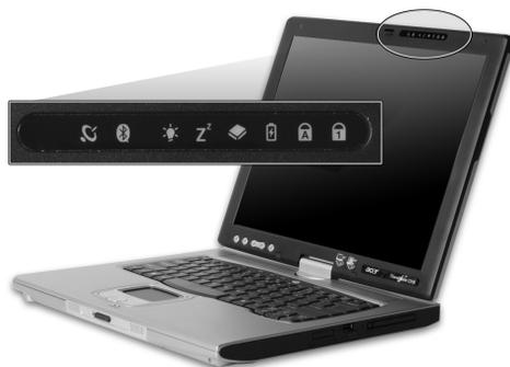
Gli indicatori di corrente, batteria e comunicazione wireless sono visibili anche quando il display LCD è chiuso.
