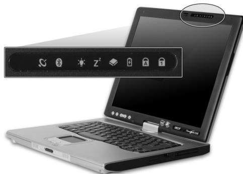
Os indicadores de estado Liga-desliga, Bateria e Comunicação sem fios podem ser vistos mesmo com o ecrã de cristal líquido fechado.
