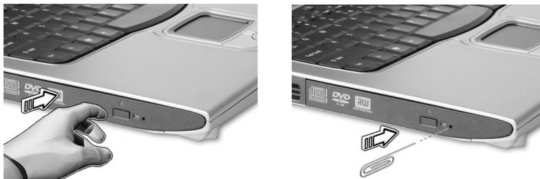
Com a energia desligada, pode-se ejectar o tabuleiro da unidade utilizando o furo de ejecção de emergência.
