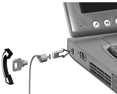
Enrole um cabo de bloqueio de segurança do computador em torno de um objecto imóvel, como por exemplo uma mesa ou o puxador de uma gaveta fechada. Introduza o bloqueio na ranhura da chave de protecção de segurança e rode a chave para proteger o bloqueio. Também estão disponíveis modelos sem chave.
