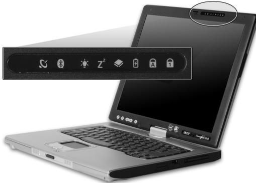
Los indicadores de estado de encendido/apagado, Batería y Comunicación inalámbrica pueden ser vistos con la pantalla LCD cerrada.
