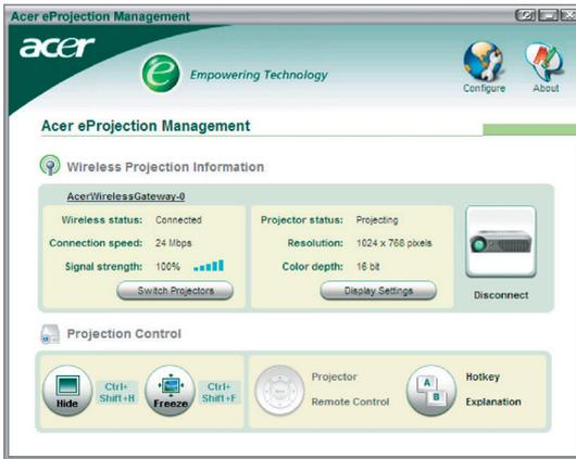
應用程式便會自動偵測可用的WPGs。每個WPG皆可藉由SSID中的“AcerWirelessGateway-”指示字樣來識別。若投影機是安裝在固定位置上，您也可以選擇指定特定的SSID至該投影機，例如指定安裝該投影機的房間編號（請參見此指南後面的“Configuration（組態設定）”）。
