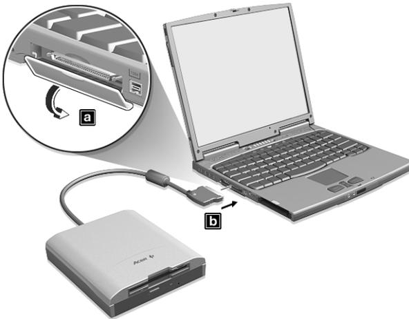
Neem de volgende stappen om het EasyLink-combostation los te koppelen:
