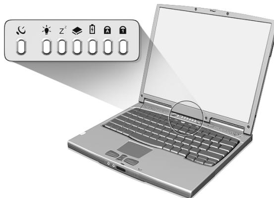
De pictogrammen van de voeding en de slaapstand zijn ook zichtbaar wanneer het scherm is gesloten, zodat u de status van de computer kunt vaststellen wanneer de klep is gesloten.
