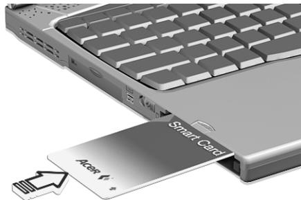
Als u de SmartCard wilt verwijderen, drukt u op de uitwerpknop voor de SmartCard (a) en verwijdert u de SmartCard (b), zoals in de volgende illustratie is weergegeven.
