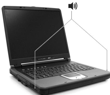
O volume é ajustado através de software, como o Controlo de Volume do Windows, as teclas Fn de Volume ou qualquer outra aplicação que oferece controlo de ajuste do volume.
