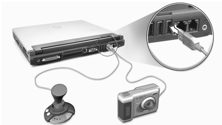
O padrão USB é Plug-and-Play, o que significa que é possível ligar e começar a utilizar um dispositivo USB sem ter que reiniciar o computador. Pode-se também desligar o dispositivo a qualquer instante.
