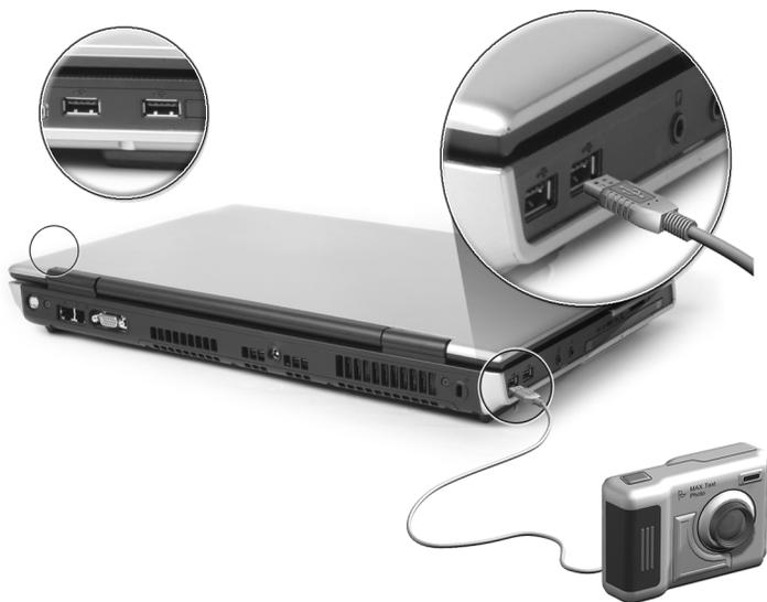
O padrão USB é Plug-and-Play, o que significa que é possível ligar e começar a utilizar um dispositivo USB sem ter que reiniciar o computador. Pode-se também desligar o dispositivo a qualquer instante.
