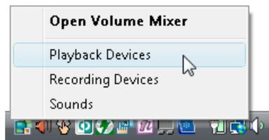
Abre-se a caixa de diálogo de Dispositivos de Reprodução. Existem três separadores: **Reprodução**, **Gravação** e **Sons**. Clique no separador **Reprodução** e depois seleccione **Saída Digital Realtek** e clique em **Configurar Predefinição** para configurar a saída digital.
