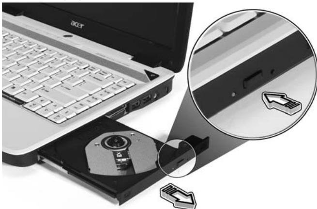
Com a alimentação desligada, é possível ejectar o tabuleiro da unidade utilizando o furo de ejeção de emergência.
