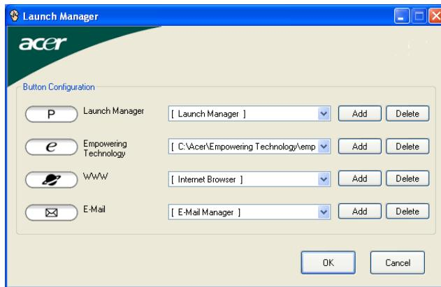
Программа Launch Manager позволяет задавать действия для 4 кнопок быстрого запуска, расположенных над клавиатурой. См. **"Кнопки быстрого запуска" на стр. 28**, где показано расположение кнопок быстрого запуска.
