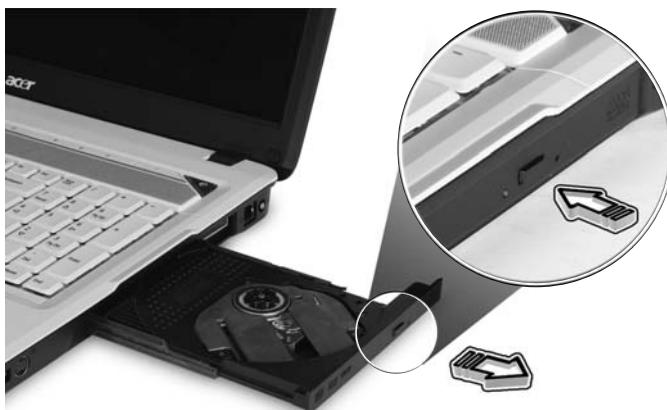
Na vypnutom počítači môžete opticú mechaniku vysunúť pomocou otvoru pohotovostného vysunutia.
