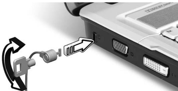
Pripojte kábel bezpečnostného zámku počítača k nepohyblivému predmetu, napríklad stolu alebo držadlu zaistenej zásuvky. Vložte zámok do otvoru a otočte kľúčom kvôli zaisteniu zámku. Niektoré modely sú dostupné aj bez zámku.
