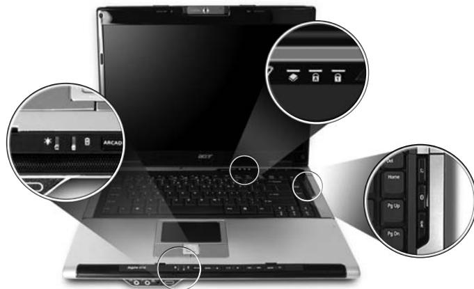
Индикаторы на передней панели видны даже при закрытой крышке компьютера.
