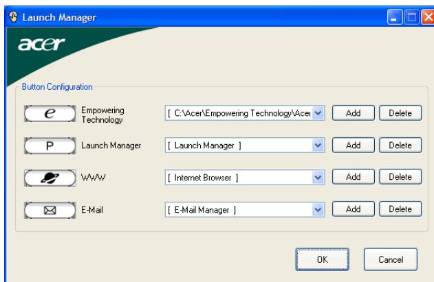
Программа Launch Manager позволяет задавать действия для 4 кнопок быстрого запуска, расположенных над клавиатурой. См. "**"Кнопки быстрого запуска"** на стр. 31, где показано расположение кнопок быстрого запуска.
