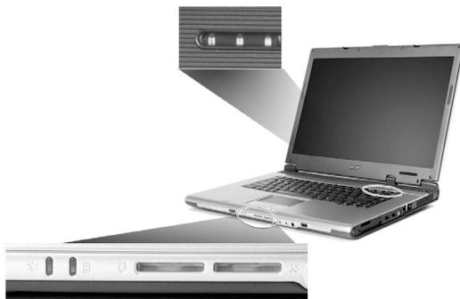
Gli indicatori di alimentazione, batteria e collegamento wireless sono visibili anche quando il display LCD è chiuso.
