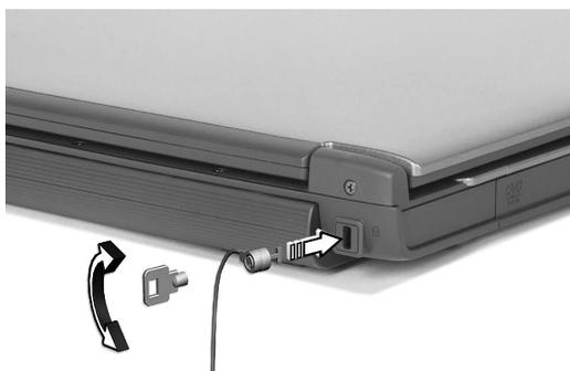
Avvolgere un cavo di sicurezza per computer intorno ad un oggetto fisso, ad esempio un tavolo o la maniglia di un cassetto chiuso a chiave. Inserire la serratura nel foro e girare la chiave per fissare il blocco. Sono disponibili anche modelli senza chiave.
