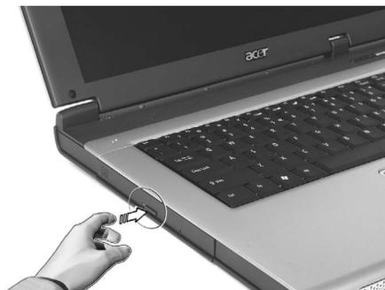
Quando è spento, è possibile espellere il vassoio del drive utilizzando il foro di apertura di emergenza.
