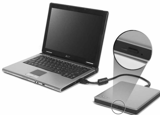
Quando il computer è spento, è possibile espellere il vassoio dell'unità utilizzando il foro di espulsione di emergenza.
