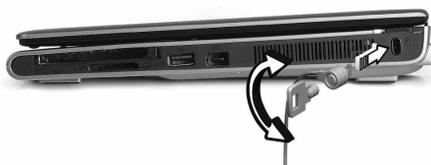
Avvolgere un cavo di blocco di sicurezza per il computer intorno ad un oggetto fisso, ad esempio un tavolo o la maniglia di un cassetto chiuso a chiave. Inserire la serratura nel foro e girare la chiave per fissare il blocco. Sono disponibili anche modelli senza chiave.
