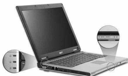
Gli indicatori di Corrente, Batteria e comunicazione Wireless sono visibili anche quando il display LCD è chiuso.
