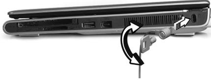
Enrole um cabo de bloqueio de segurança do computador em torno de um objecto imóvel, como por exemplo uma mesa ou o puxador de uma gaveta fechada. Introduza o bloqueio na ranhura da chave de protecção de segurança e rode a chave para proteger o bloqueio. Também estão disponíveis modelos sem chave.
