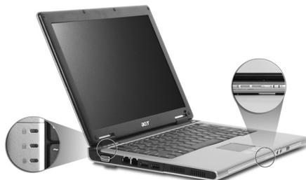
Os indicadores de estado Liga-desliga, Bateria e Comunicação sem fios podem ser vistos mesmo com o ecrã de cristal líquido fechado.
