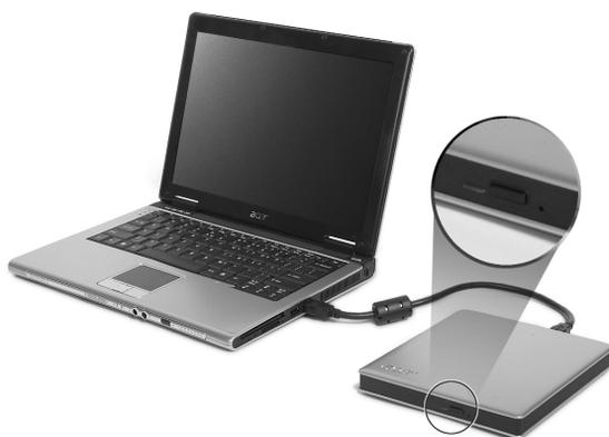
Quando a corrente está desligada, pode ejectar o tabuleiro da unidade utilizando o orifício de ejeção de emergência.
