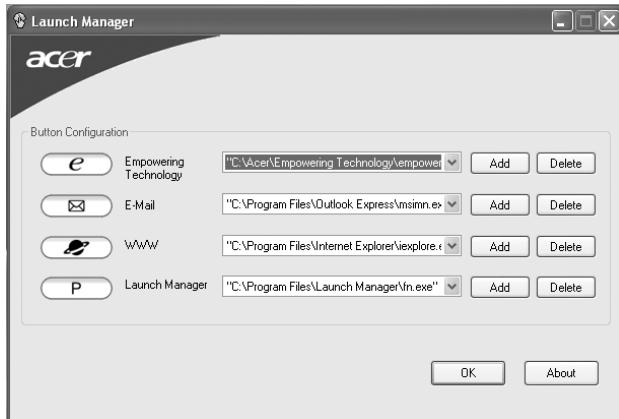
Программа Launch Manager позволяет задавать действия для 4 кнопок быстрого запуска, расположенных над клавиатурой. См. **"Кнопки быстрого запуска" на стр. 25**, где показано расположение кнопок быстрого запуска.
