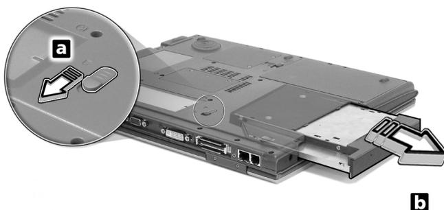
Insérez ensuite le module AcerMedia en option dans la baie AcerMedia jusqu'à ce qu'il se mette en place avec un déclic.
