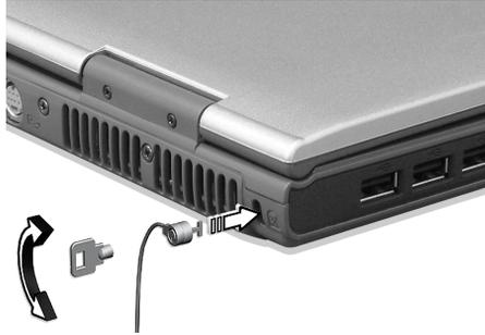
Enroulez le câble du cadenas de sécurité pour ordinateur autour d'une table, de la poignée d'un tiroir verrouillé, ou de tout autre objet fixe. Insérez le cadenas dans l'encoche et tournez la clef pour verrouiller le cadenas. Certains modèles ne possèdent pas d'encoche.
