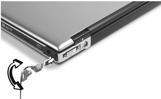
Enroulez le câble du cadenas de sécurité pour ordinateur autour d'une table, de la poignée d'un tiroir verrouillé, ou de tout autre objet fixe. Insérez le cadenas dans l'encoche et tournez la clef pour verrouiller le cadenas. Certains modèles ne possèdent pas d'encoche.
